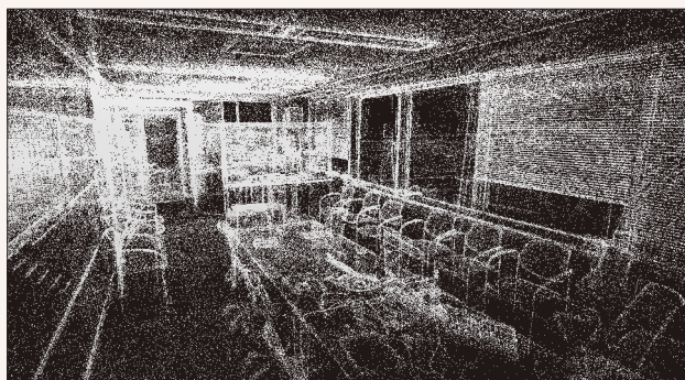
写真2 ActiVRのもととなる点群データ
